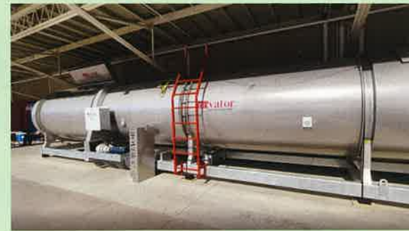
図6 ドラム型へい獣たい肥化促進機 (BIOvator)
